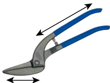
Em tesouras metálicas standard, as arestas de corte e as pegas são habitualmente forjadas, compondo apenas uma peça. A força necessária para cortar é determinada pela relação entre o comprimento da aresta e o comprimento da pega.
