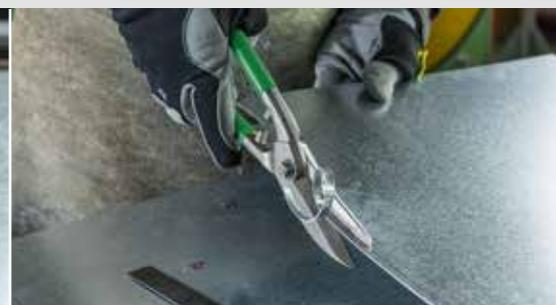
**Tesoura de punção com lâminas curvas**
