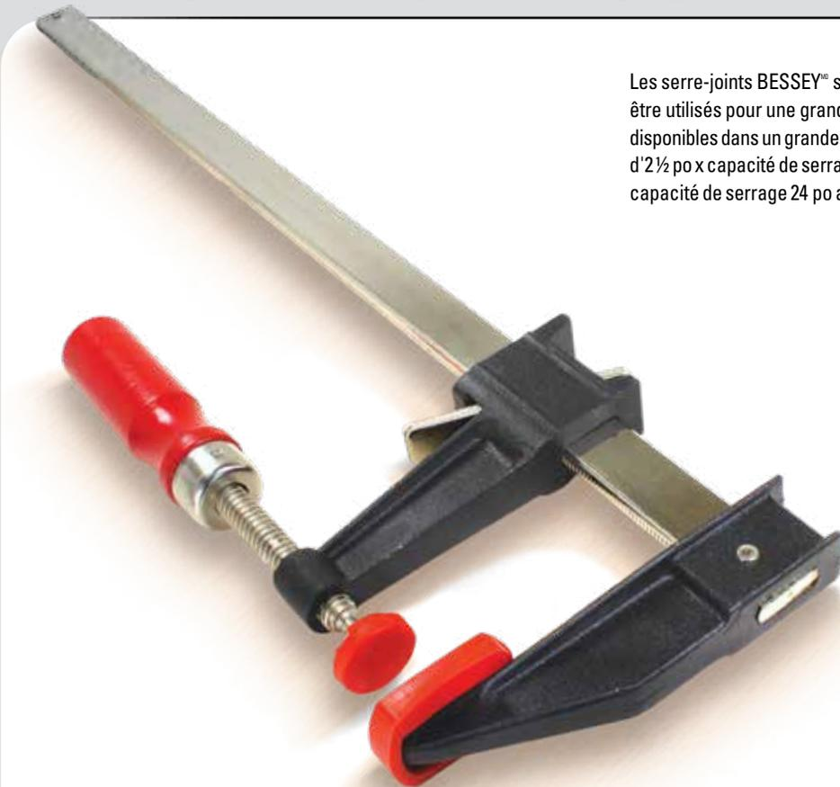
Les serre-joints BESSEY® style embrayage sont des serre-joints populaires pouvant être utilisés pour une grande variété de projets. Ces serre-joints économiques sont disponibles dans un grande gamme de tailles, du GSCC2.506 avec profondeur de gorge d'2 ½ po x capacité de serrage de 6 po au GSCC5.024 avec profondeur de gorge 5 po x capacité de serrage 24 po ainsi que des pression de serrage allant de 600 à 1200 lb.
