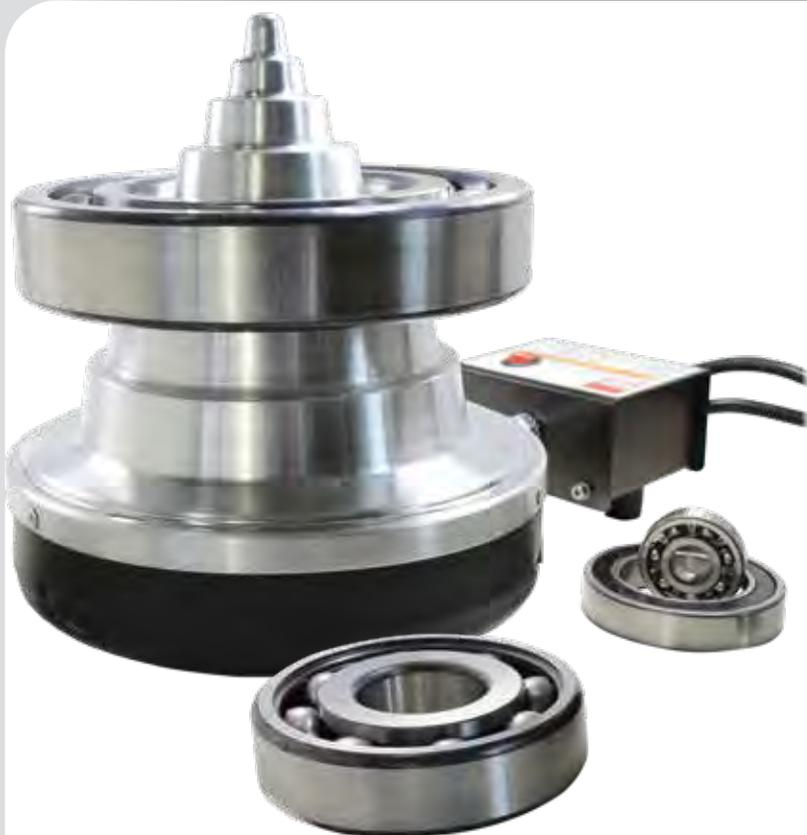
Le chauffage permet aux paliers de prendre l'expansion nécessaire pour les ajuster avec précision sur l'arbre sans risquer de les endommager. Installer un palier froid sous pression sur un arbre peut entraîner un mauvais alignement du palier et une différence dans la position du palier aussi petite que 0,001 po peut réduire sa durée de vie de 50 %.
