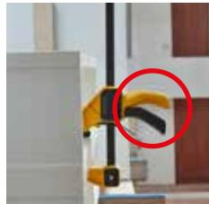
Риск повреждения деталей и получения травмы повышается при работе с деталями в ограниченном пространстве, когда зажимной инструмент используется без достаточного визуального контроля.
